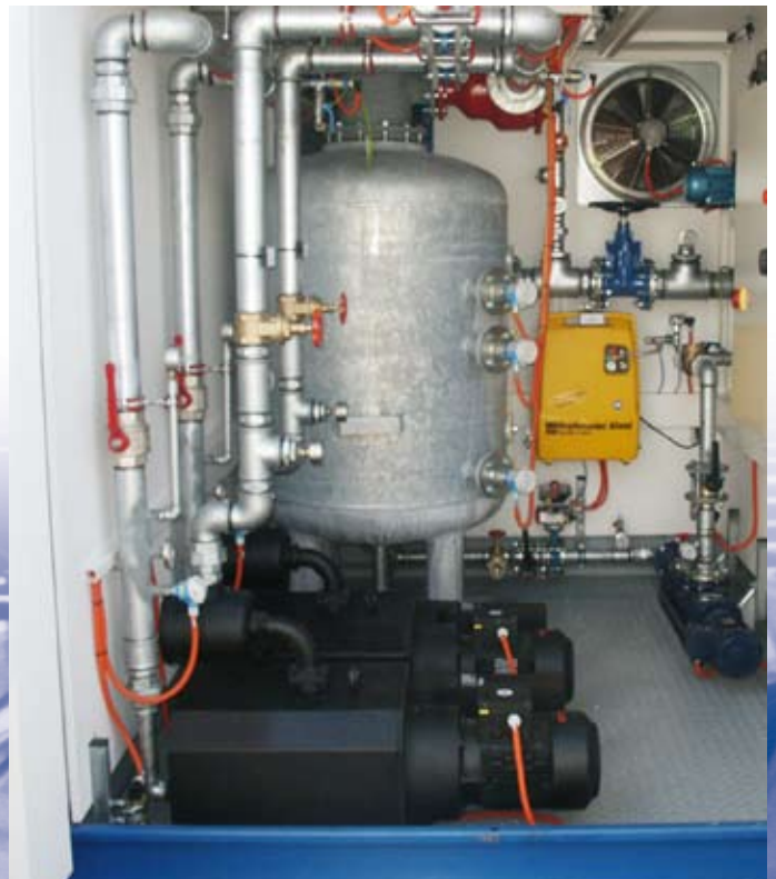
HVE-Container mit Gebläsen, Festverrohrung, Flüssigkeitsabscheider und Schaltschrank
