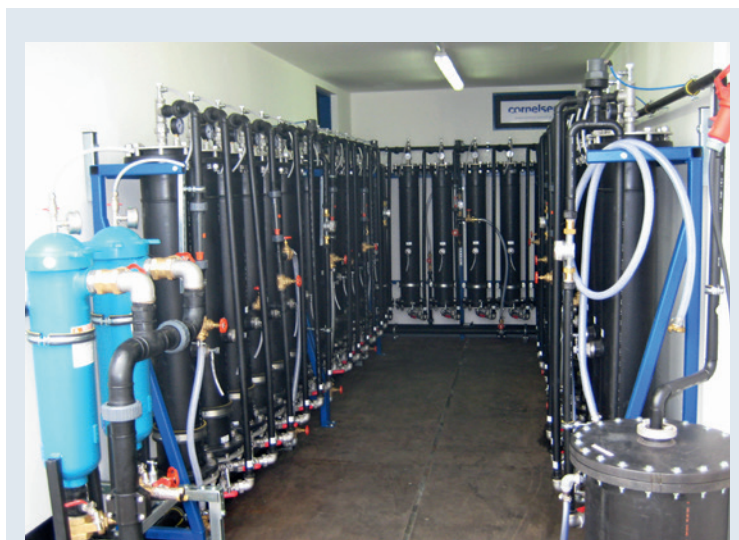
Bild 1: Säulen-Testanlage für eine vergleichende Beurteilung von Adsorbentien
