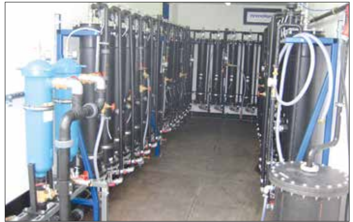
03 Testanlage für vergleichende Beurteilung von Adsorbentien
