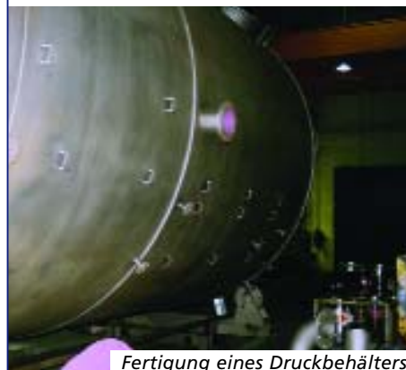
Fertigung eines Druckbehälters
